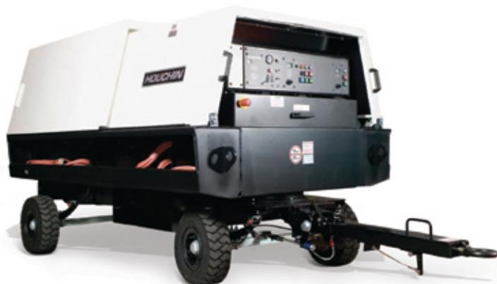
**C690** является малошумным авиационным источником питания, подходящим для обслуживания электрических систем переменного тока частотой 400 Гц и постоянного тока 28В на всех типах воздушных судов.
